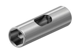
La llave de fijación sirve para el apriete a prueba de momento de giro de la tuerca de fijación del RollerDrive con ayuda de una llave dinamométrica. El vaso dispone de una abertura lateral a través de la cual se puede extraer el cable de conexión del RollerDrive.
