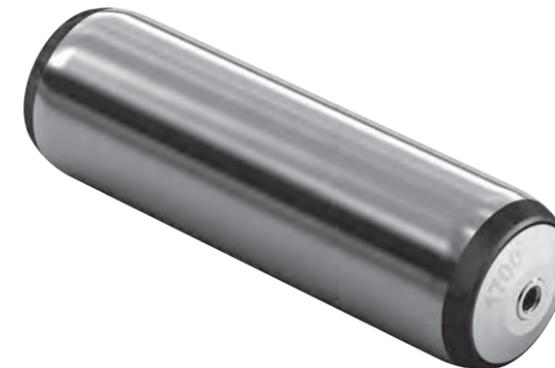
Los ejes de rosca interior facilitan, a diferencia de los ejes de muelle, una estructura muy estable del marco y son mucho más silenciosos que los rodillos transportadores montados de forma suelta. Los ejes de rodillo y los perfiles se estabilizan mutuamente, de modo que los rodillos transportadores pueden someterse a cargas más altas que en el caso de una sujeción suelta. El montaje y desmontaje requieren más tiempo que en ejes de muelle.
