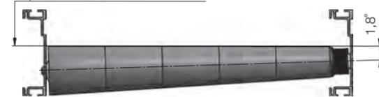
Durante la construcción de la curva debe prestarse imprescindible atención a que la superficie de la camisa de los elementos cónicos esté en posición horizontal. Por este motivo el eje del rodillo transportador tiene una inclinación de 1,8°.
