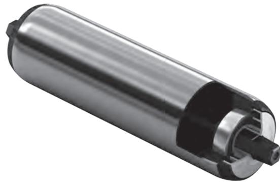
El eje cónico, provisto de resorte interior, combina las ventajas de ejes de muelle y ejes de rosca interior: Rápido montaje y nivel de ruido muy bajo.
